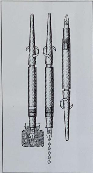
Klassische Kolbenmechanik zum wirtschaftlichen Füllen aus dem Tintenglas. Das bedeutet: Leichte Reinigung, einfacher Wechsel der Tintenfarbtöne, keine Verschmutzungsgefahr durch angestoche Tintenpatronen.
